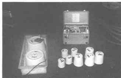
図-8 小型超音波発信機を埋め込んだトレーサー
