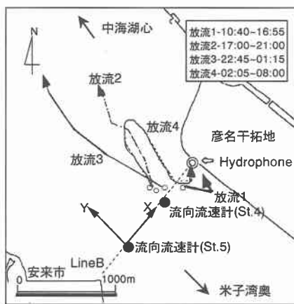
図-7 密度 19.5 \text{ kg/m}^3 の位置(水中)に浮かせた浮子の軌跡
