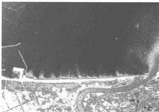
写真-1 SPOT の衛星画像による石狩川河口周辺における streak 状の濁水流出パターン (1986 年 10 月 1 日 10:40; 灘岡ら, 1988)
