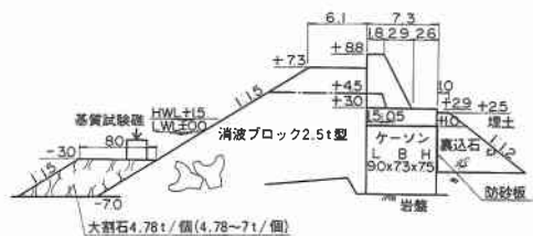
図-4 試験ブロックの設置場所（浦海港）
