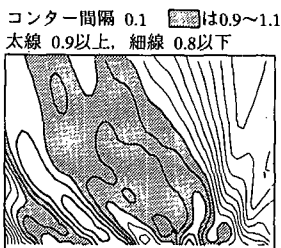
図-7 無次元波高の平面分布 (設定波向 22.5°, 水深 0.6 m, 周期 1.8 秒, 対象領域: 領域 A)
