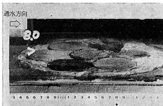
写真-3 軟岩(砂岩)の供試体表面 ( \bar{u}=8.0 m/s)
