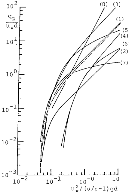
図-6 式 (8) と各種流砂量式との比較
