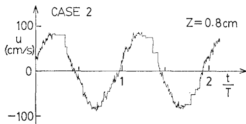
図-3 LDV による移動層内の流速測定例
