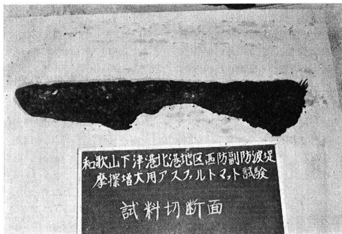
写真-2 アスファルトマット採取試料切断面
