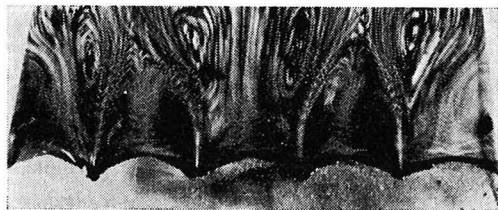
図—2 m=5 の subharmonic edge wave によって誘起される循環流パターン
