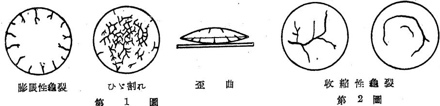
化を生ずるセメントの品質は之を信用することは出来ない。第2圖に示すものは之と往々見誤られる所謂收縮性龜裂(Shrinkage crack)の例である。之はセメントの品質とは關係なく、饅頭形體が浸水前に乾燥し過ぎた爲に生ずるものであつて試験方法の缺陷に歸すべきものである。
