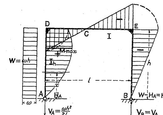
$$= \frac{3}{4} \omega.h. \frac{1 + \frac{11}{18} \nu}{1 + \frac{2}{3} \nu} \\ \sim \frac{3}{4} \omega.h. \dots \dots \dots (102)$$
