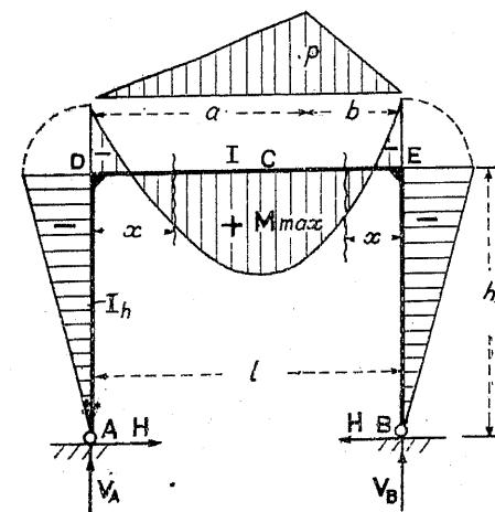
$$V_A = \frac{p}{6} \cdot (b+l) \quad \dots\dots\dots(1012)$$
