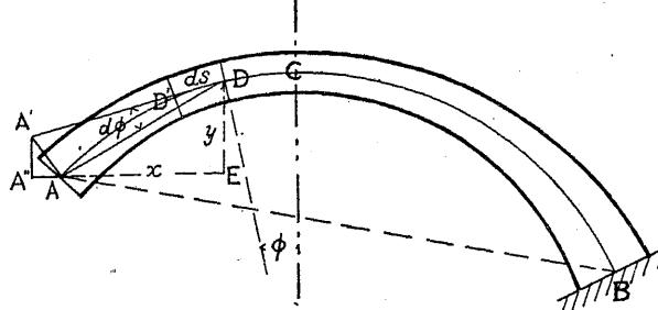
非常ニ近接セル断面ガ其重心點間ノ距離 $d_s$ ヲ變ゼズシテ相互 $d\phi$ ナル角變位(Angular displacement)ヲ受ケタルモノト考フレバ其結果
