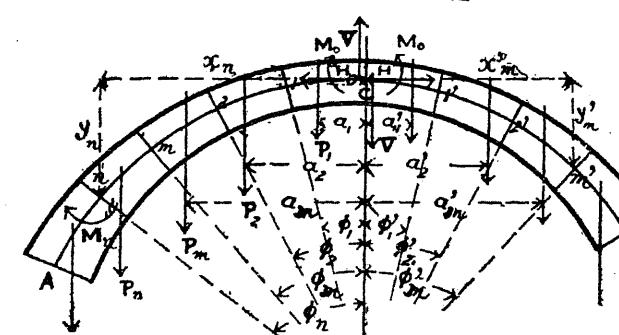
兩断セラレタルモノト考エ其斷面ニ於ケル繼手壓力 (Joint pressure) ヲ外力トシテ取扱ヒ之ヲ斷面ノ重心點ニ働ク
