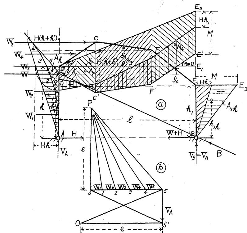
距離ハ  $AD$  及  $DC$  ナル部材ニ對スル各  $W$  ノ力率ヲ示スモノトナル可シ而シテ  $CF$  及  $FE$  ナル部材ニ於ケル力率ハ又 0 及 5 ナル最終線ノ相互水平距離ニテ示サル可シ故ニ  $DCFE$  ナル部材ニ於ケル單純力率ハ  $DE_1$  ナル水平線上ニ建テタル縦距ノ連結線  $D'C'F'E'$  ニテ示スコトヲ得可ク更ニ  $W$  ナル合成風壓ノ延長線ガ  $DOFE$  ナル部材ト交叉スル點ニ於テ力率ハ零トナル可シ。
