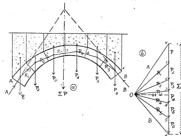
分タレA及Bナル終端斷面ハ緊定セル拱臺 (Abutment) = 休止スルモノトス然ルトキハ各拱石假令バ1-2ハ $P_2$ ナル外重及其接續繼手面ニ於ケル $R_1$ 及 $R_2$ ナルニツノ合成壓力ノ作用ヲ受ク可シ此等ノ力ハ互ニ平衡ヲ保持セザルベカラズ從ツテ1-2-0ナル力ノ三角形 (Force triangle) = 依ツテ之ヲ表ハスコトヲ得可シ此方法ニ據リテ繼手ニ於ケル壓力 (Joint pressure)ハ其何レカ一ツヲ知レバ他ノ一ツヲ確定スルコトヲ得可ク從ツテ繼手ニ於ケル壓力ノ凡テハ夫等ノ力ノ或一ツノ力量 (Magnitude), 方向 (Direction) 及働く點 (Point of application)ヲ知レバ順次之ヲ見出スコトヲ得可シ A 及 B ナル終端面ニ働く力ハ拱端壓力 (Abutment pressure)ニシテ之ニ對抗スル力ヲ拱端反應力 (Abutment reaction) ト云ヒ A 及 B ヲ以テ之ヲ表ハストキハ拱ハ $\Sigma P$ 及 A,B ノ三力ニ依リテ平衡狀態ニアルモノト考フルコトヲ得可シ.
