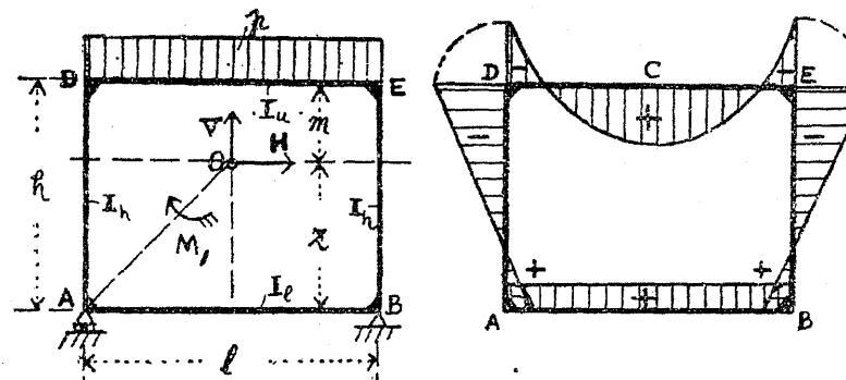
ノ一 支點 B ハ緊定シ他ノ支點 A ハ自由ナルモノト假定シ左右部材ノ物量力率ハ何レモ相等シク  $I_u$  ヲ有スルモノトス更ニ  $I_l$  ヲ上部材,  $I_b$  ヲ下部材ノ物量力率ヲ示スモノトセバ其相互ノ關係多様ナル丈ケ其解法モ亦複雜ナルヲ以テ今垂直及水平等布荷重ヲ有スル場合ニ限リ之ヲ説明ス可シ既述ノ場合ト同ジク
