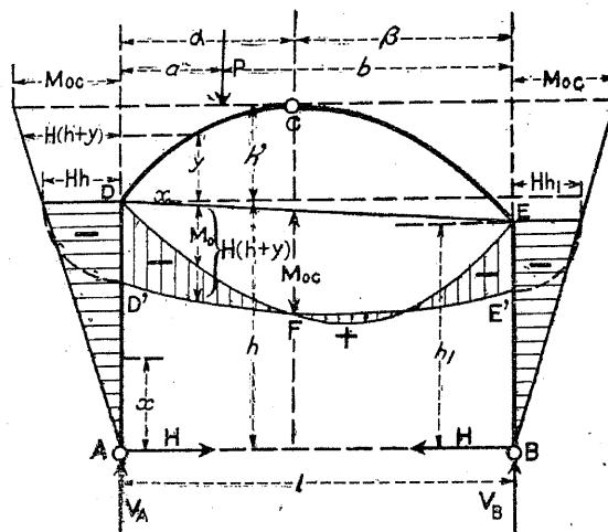
トシテノ或一點ニ於ケル彎曲力率ヲ $M_0$ トシ樁構ノ未知水平推力ヲ $H$ トセバ拱頂Cニアリテハ
