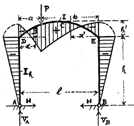
$$V_A = \frac{P.b}{l} \quad \dots \dots \dots \quad (1128)$$
