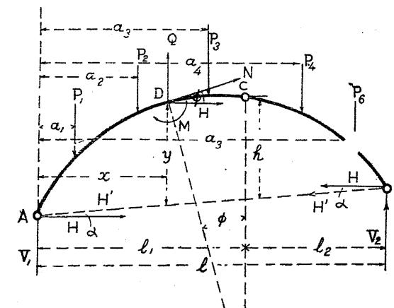
フテ勧ク推力(Thrust)ヲ  $H'$  トシ其水平推力ヲ  $H$  トセバ  $H' = H \sec \alpha$
