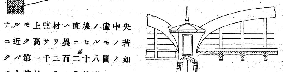
ナルモ上弦材ハ直線ノ儘中央ニ近ク高サフ異ニセルモノ若クバ第一千二百二十八圖ノ如ク上弦材ハ全ク曲線形ヲナセ
