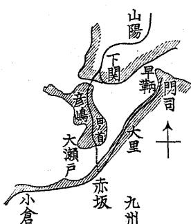
の大要を述ぶれば下關停車場の西方山陽線 328 哩附近から西方へ分岐して小瀬戸を越え彦島を縦断して田ノ首附近から大瀬戸の下を抜けて九州の赤坂信号所附近までは水底 1 哩(1.6 基米)兩取附き各  $1\frac{1}{2}$  哩(2.4 基米)合計凡そ 4 哩餘(6.4 基米)のトンネルで聯絡するので門司へは通せず直に小倉の方へ通するのであるから
