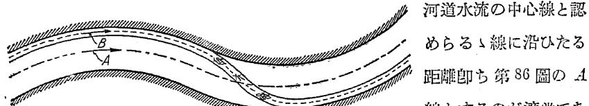
第 86 圖 縦断面圖に於ける距離の取り方
