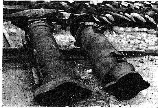
第 515 圖 「シールド」用水圧「ジャッキ」 左 丹那隧道に使用のもの 右 折渡隧道に使用のもの
