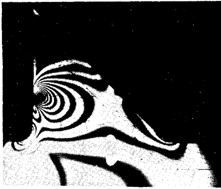
図-3.2 Filletの大きさとそれに生ずる集中応力との関係(外荷重が作用した場合)
