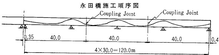
4ケーブル使用しており、桁コンクリートの打設は支保工上にて実施した。打設法としては桁1連を図のごとく3ブロックに分け、第1ブロックを打設、プレストレス導入後、第2ブロックに移るという順序でつぎつぎと支保工・型ワクを転用していった。
