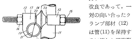
の凹み(13)を有し凹みの軸と直角方向にボルト(15)挿通用の穴が設けられている。クランプ部材の間でボルト上に位置する座金(14)は隣接するクランプ部材の凹みと同じ半径で内方に弯曲した両面を有し, クランプ部材, 座金, ボルトを図のように配置しボルト両端をナット(16)で緊締する。(特許庁審査第二部 荒木達雄)
