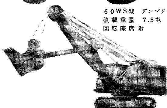
605型パワーショベル 掘削容量 1.2 m<sup>3</sup>
