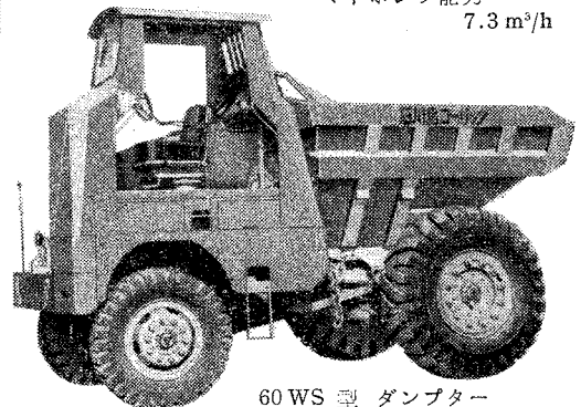
60 WS 型 ダンブター 積載重量 7.5 吨 廻転 座席型
