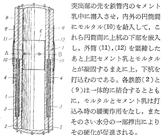
突出部の先を鉄管内のセメント乳中に潜入させ、内外の円筒間にモルタル(10)を給入して、これら円筒間に上杭の下部を嵌入し、外筒(11),(12)を緊締したあと上記セメント乳とモルタルとが凝固するまえに上、下杭を打込むのである。各鉄筋(2)と(9)は一体的に結合するとともに、モルタルとセメント乳は打込み時の緩衝作用をなし、またそのさい水分の一部擰出によりその硬化が促進される。
