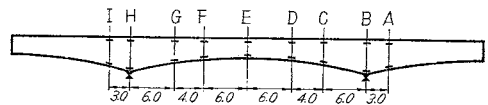
図-18(a) 死荷重による鉄筋ヒズミ B.H. 下縁 (图中 No. は横断方向の測点 No.)
