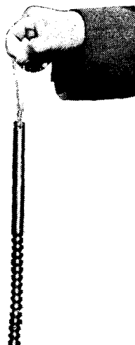
図-4 地下水位精密測定用ゲージ
