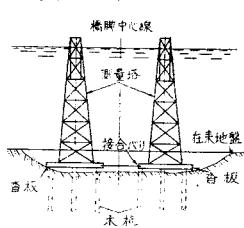
る鋼杭の頭の上に 1.5m 厚の水中コンクリートを打込む。この輪型の上に 3 本の鋼管ラチスマストを立て、その頭を三角形横パリで結ぶ。これはプレキャスト鉄筋コンクリート部材の誘導と水中コンクリート打込用パイプの誘導に役立つ。
