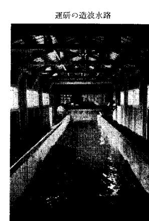
である。造波水路の規模が大きいので実物の1/10~1/5の縮尺で実験できるためにきわめて精度が高く、この水路で実験することによって来襲波浪の防波堤および海岸構造物におよぼす影響についての新事実が、つぎつぎと究明されてゆくことと思われる。
