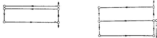
図-8 はベルトコンベヤを部分的に 2 条配置したときの S.J. 方式による貯炭設備によるベルトコンベヤ配置図である。
