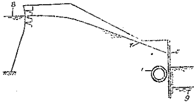
圖-4. 集水暗渠個所の横断面
