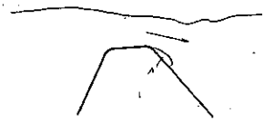
圖-41. 下流側勾配の急な溢流堰
