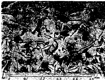
第 44 圖 鑄造體徑 36 mm ピクリン酸にて腐蝕 倍率約 90 倍 甲工場のものゝ如く亞共晶はなけれども微細なる黒鉛及びパーライトより成る
