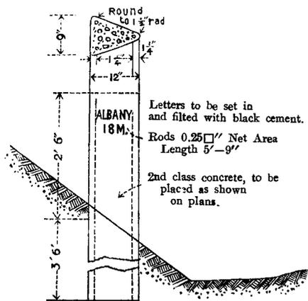
○鐵筋混凝土埋程標
