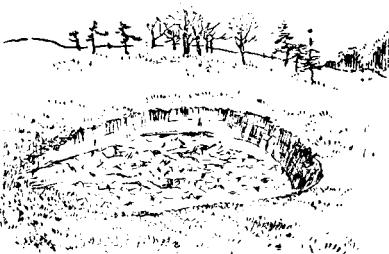
近イ地面ガアツテ、此平ラニ近イ所ハ一面ニ烈シイ地割。レカ有テ波ヲ打ツタ様ニヒドク荒レテ居リマス、ソレカラマタヌルイ斜面ニ移變ツテ居リマス。(第五圖)金谷ノ墜道ガ壞ハレテカラ、此邊ノ地勢ノ奇妙ナルコトガ目ニ着キマシタガソレマデハ此地勢ニ注意ヲシタモノハナイ様デアリマス、是ハ昔ノ大キナ山崩レノアツタ痕跡ガ今ニ殘ツテ居ルモノト思ヒマス、又タ東海道ノ鐵道デ大井川ヲ渡ツテ金谷ノ停車場ニ行ク途中ニ左ノ方ノ殆平ラナ所ニ極低イ切取リガアリマス、是ハ鐵道ノ規則デ切取ツテアリマスガ茲ハ少シ押出ス傾ガ見エテ、ソレカラ又割レル崩レル押スト云フコトガ一緒ニ伴ツテ居ルノデアリマス、決シテ岩ガ質ガ惡イカラ崩レルトハ言ヘマセシ、(第六圖)同所ノ字モチブチ變動地ノ略斷面點線ハ鐵道線ヲ始テ敷キタル
