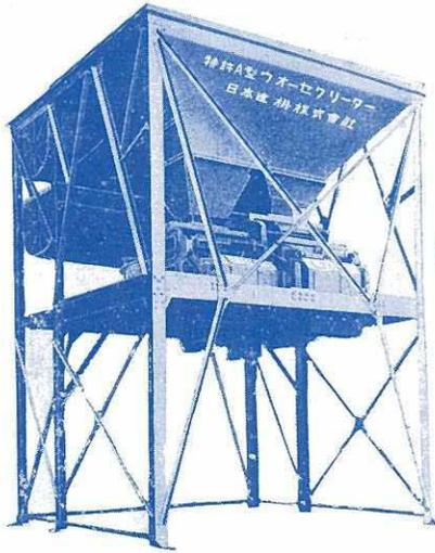
混 凝 土 配 合 調 整 機
