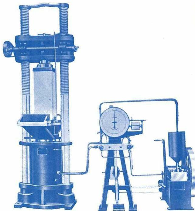
東京衡機アムスラー型三百噸耐壓及彎曲試驗機
