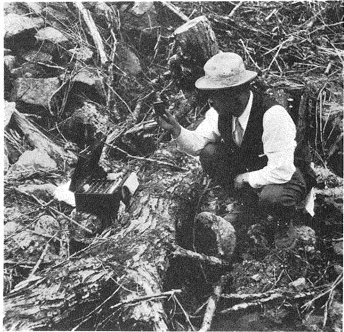
寫眞6、湧水箇所 に於ける水の採取と採水検査の實況。
