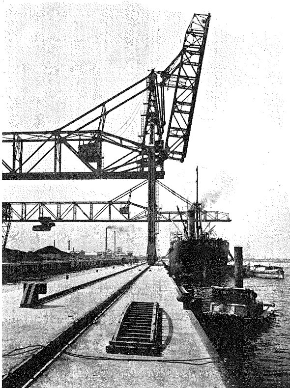
写真 5. 日満埠頭平行棧橋南端より見たる 石炭荷役状態、手前のトランスポ ーターは移動中。
