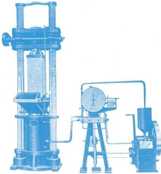
東京衡機アムスラー型三百吨耐壓及彎曲試驗機 特許東京衡機式改良振子動力計附
