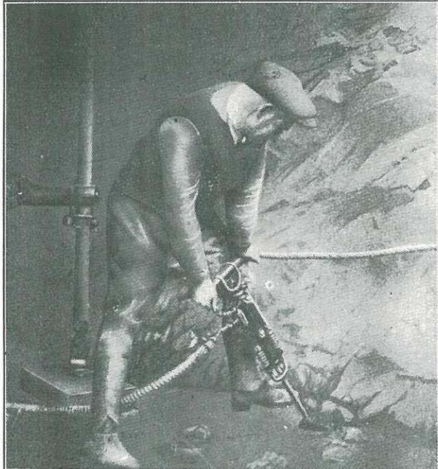
Hard Rock Drilling の鑿岩機として最も卓越せる偉彩を示す 7 號と 17 號型は同じ構造を有す只し後者は前者に比較してシリンダーが大きく總體 Heavy 型である、共にスピードとパワーの強大なる點は特筆すべき點である。殊に併用さるべき自動給油装置ラインオライヤー 3 A の効力は偉大なるもので油の消費を半減し能力を増大せしむるものである、他の鑿岩機に比して突起部分少く極く頑丈で信頼出来るものである、米國著名のトンネル開鑿には専ら本機を専用せられた。
