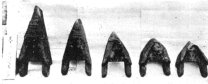
(1) (2) (3) (4) (5) シヨベルのデイツバー附屬掘鑿爪磨滅進行の狀態 材質マンガン鋼にして一個の重量 45 廻(3)迄に交換し普通 3,500 立坪位迄を掘鑿す。
