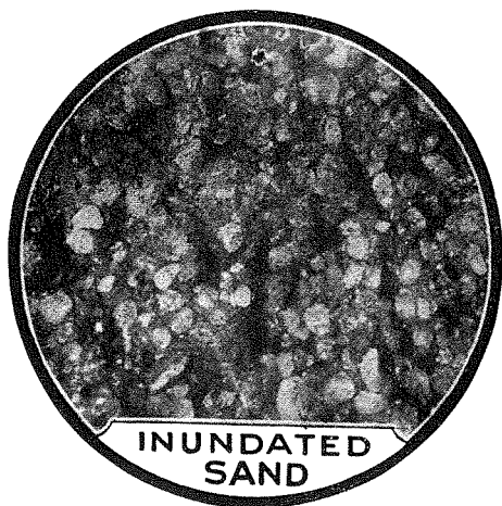
第3圖 水にて飽和せし砂 (密度の密なるを示す)
