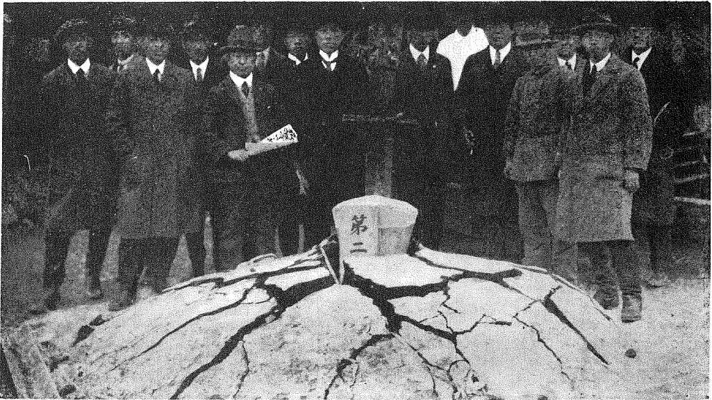
(13) 第二號供試體（塊狀基礎）を引き抜きし所。圖は供試體が六萬封度の上曳力を受けし光景にて此の際の地表の裂罅は半徑約五呎の圓周内に起れり。 寫眞前列向つて左より二人日紙片を手にするは本發明者白石信親氏、同三人日太刀川工學博士、其の後方は佐伯工學士、前列四人日山倉工學士、五人日奥村工學士にして他は當日參會せる技術家の一部とす。 (13) Pulled up the Foundation No. 2, with a Tension of 60,000 lbs.
