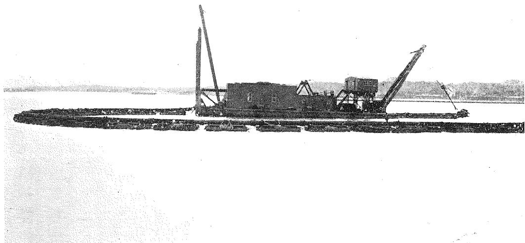
(3) 渋渫用立電氣サンドポンプ船。航走能力一時間揚土量六十立坪、送泥距離五〇〇〇尺、船體長一二〇、幅三五、深八、電動機サンドポンプ一〇〇〇HP。カッター一五〇HP。補助ポンプ四〇HP。ウインチ五〇HP。空氣壓搾機五〇HP。送泥管直徑二〇"。海上は鐵管、陸上は木管を使用、ポンプ室サンドポンプ二〇"セントリフューガル型、電動機交流三相誘導型、一〇〇〇HP、三〇〇〇V、五〇～三七五RPM、カッターヘッド直徑六尺一五RPMノ電動機一五〇HP。
