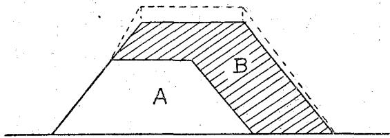
圖に就て言ふと、Aといふ舊道路が五米幅のものがあつたのをBの様に擴築するといふ場合には、やはり、餘盛をするのであります。實際のやり方はどうするかといふと、Bだけの土量に對して一割なら一割、二割なら二割を加へるといふことをやるのであります。ところが實際に要する土量は決してBの一割では済まないのであります。Bの土を加へますとAの部分も又其下の地盤も更に壓縮されますから、餘盛土量としてはAとBとを加へたもの、合計の一割位が必要になる。だからBの部分だけの土量に對しては餘盛の部分は二割にも三割にも當ることになるのであります。ところが普通はサウやらないでBだけを勘定してそれの一割とか、二割とかを取つて居るから間違が起るのです。夫故河川沿ひの所や軟地盤の所ではどうしてもAとBと加へたものに付て割増を見込まなければならぬ。是はウツカリすると、多年河川又は道路の仕事に從事して居る者でも間違へて、數十萬圓の違算を來たすことがある。自分も往々さういふ経験をしたことがあるし、又話も聞いたのであります。是はなか／＼大きな結果を來たすのでありますから、よく覺えて置いて戴きたい。
