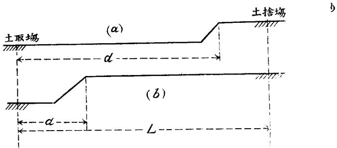
第一圖 a の如く勾配の下部長の場合には降りに際し坂部の自走が速度を利用し  $d$  部に走り込み得るを以て昇りに失ひたる遅延を取り戻し得るもの圖の如く  $d$  の部短かき場合には此利益を享くこと能はず前文屢々述べたるが如く「トロ押」の序列不整に陥るは勾配線に於て最も甚しく序列不整は人夫軀力の不平均より起り時間空費の最大原因たるを以て運搬線路及從業者の配置は可成的研究を重ね器械器具及從業者の經濟的使用に注意せざるべからず
