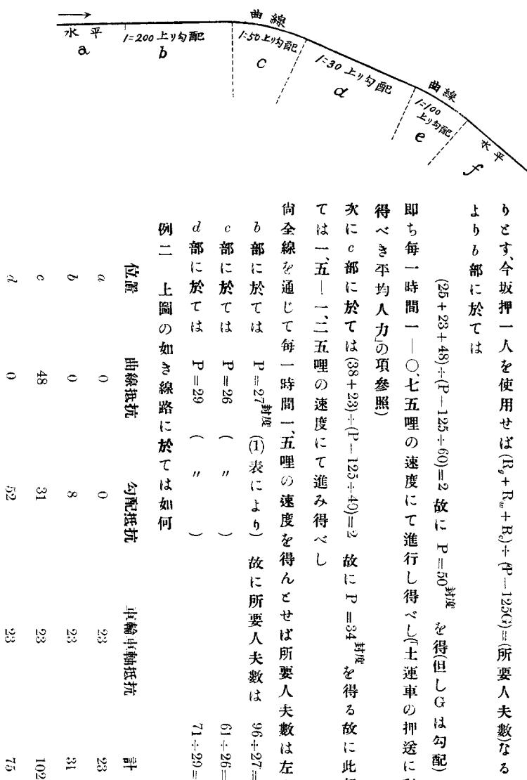
此場合は、及び $\alpha$ 部の長さ五〇一六〇間より長ければ坂押を使用するの外なし然らばれば、部に於ける勾配を $\beta$ 部に移して惰力を利用するの方法を探るべとなり
