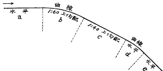
上表によればb部に於ける抵抗は人夫一人に對しては多きに過ぐるを以てb部の距離短くしてb部の精力を利用して通過し得るにあらずんばb部の勾配或は曲線何れか一つをa部に移すを適當とすべし斯くする時は其抵抗左の如くなりて各部の抵抗殆んど一様になり全線を通じ一人或は二人にて運搬せしめ得べし
