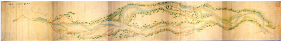
②-5-1 豊平川堤防修築計画平面図 国立公文書館所蔵 重文。今回の資料調査で新たに発見。古市の手による現存の唯一の設計図面)
