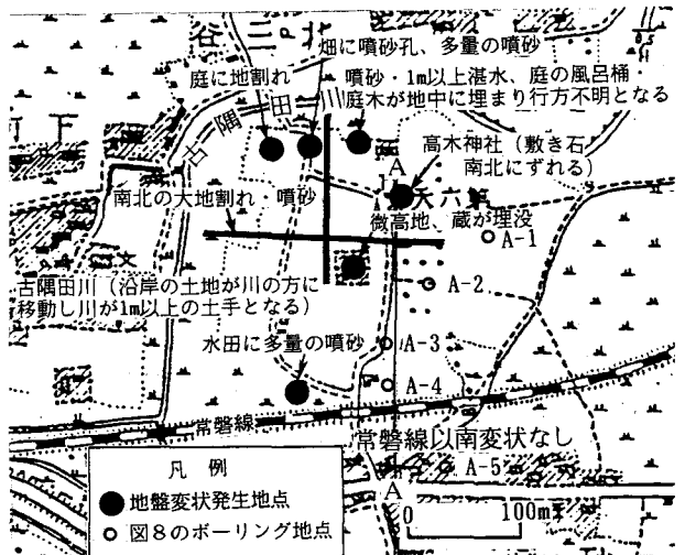
図7 西亀有高木神社付近における地盤変状
