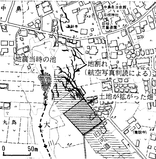
図10 茅ヶ崎市中島における地盤変状
