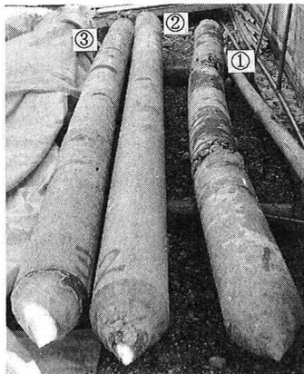
写真-3 引抜き後の杭
