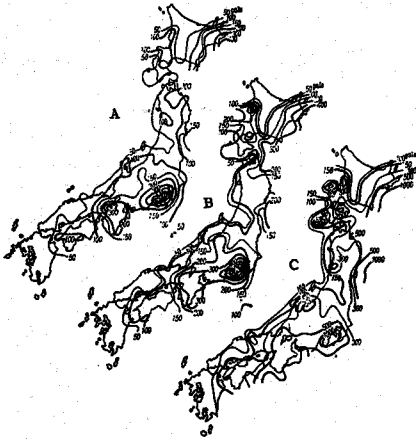
第1図 A: n=75 年, B: n=100 年, C: n=200 年 を再来年数とする最高震度期待値
