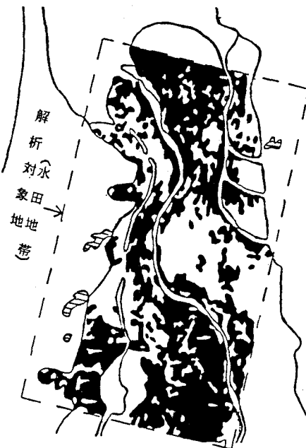
図-4 液状化発生可能地域
