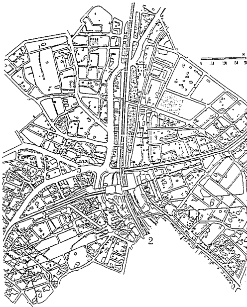
図-1 1 渋谷駅周辺の区画整理(第8-1地区) (図中の数字は、1渋谷駅、2国電、3地下鉄、4駅前広場、5放射4号線(幅員22m)、6放射22号線(幅員50m)、7新環状5号線(幅員30m)、である。)
